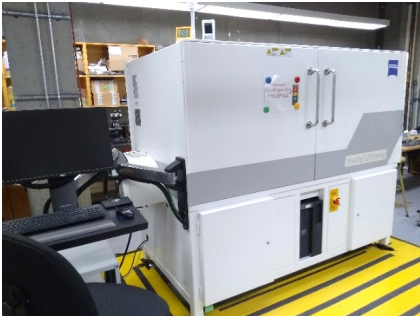
Zeiss Xradia 520 Versa Tomograph
